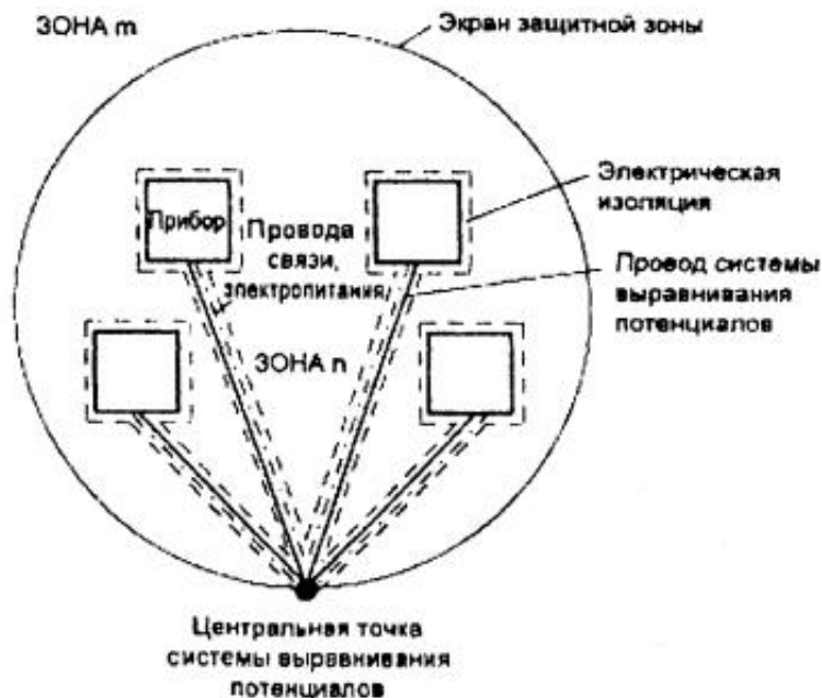
Рисунок 4.4 - Схема соединения проводов электропитания и связи звездообразной системе выравнивания потенциалов
